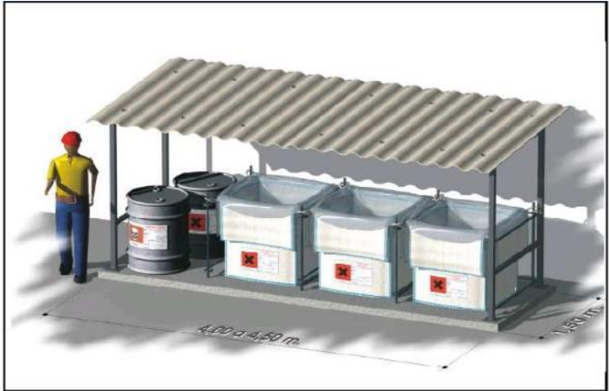
Caseta tipo para gestión de residuos peligrosos
