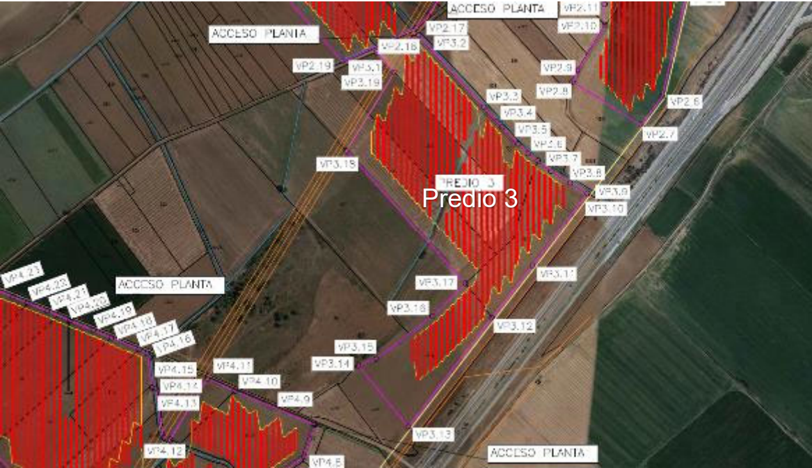
Detalle de las coordenadas de replanteo del vallado del Predio 3 (Fuente: Proyecto básico de la planta solar)
